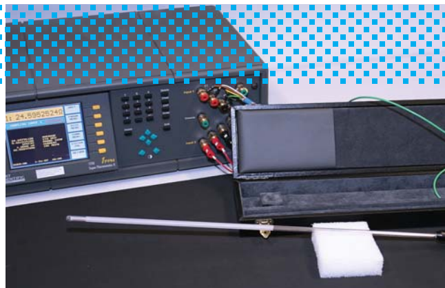
Termómetro de referencia calibrado ITS90, SPRT (Standard Platinum Resistance Thermo-meter, es decir, termómetro de resistencia de platino normalizado)
