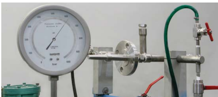
Prueba de ejecución a 900°C en un horno y prueba de presión hidrostática
